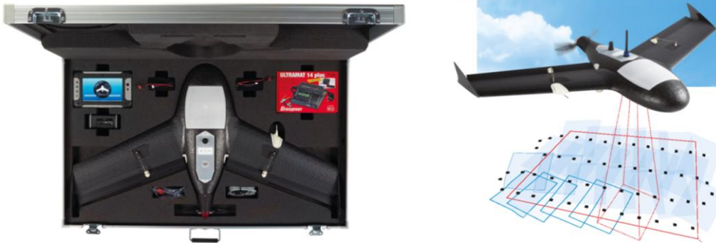
Fig. 5 : Drone X100 portable de la société Gatewing pour l'obtention d'orthophotos
