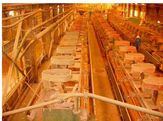
Figure 10 : Cellules de flottation dans l'usine de Chaillac, traitant la barytine extraite sur place (Cliché F. Barthélémy - BRGM 2004).
